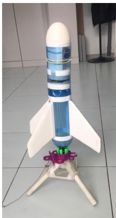
Фото 1. Пневмогидравлическая ракета с программируемой системой спасения и пусковая установка
