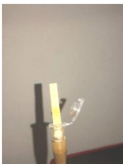
Фото 1–3. Определение рН почвенной вытяжки с помощью индикаторной бумаги
