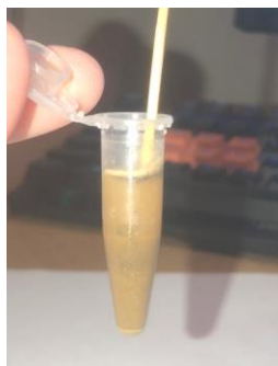
Фото 1–3. Определение рН почвенной вытяжки с помощью индикаторной бумаги
